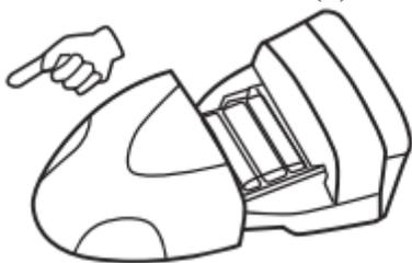
3.2.3 вставьте 6 новых батарей в батарейный отсек. Следует обратить внимание на символы полярности (+ и -), которые отмечены на соединительных клеммах металлоискателя и батарей. Полярности батареи должны совпадать с полярностью терминалов.
