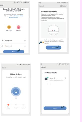
Вы можете выбрать "AP Mode" (AP Режим), индикатор начнет быстро мигать. Если указанное не произойдет, нажмите и удерживайте кнопку перезагрузки примерно 5 сек, пока индикатор не начнет быстро мигать. Подключите Ваше мобильное устройство к точке беспроводного доступа: "SmartLife-XXXX", затем нажмите "return to App" (вернуться в приложение), подключение к Wi-Fi будет выполнено автоматически, настройки будут завершены.
