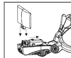
При вставке линзы пружинный зажим автоматически ее фиксирует.
