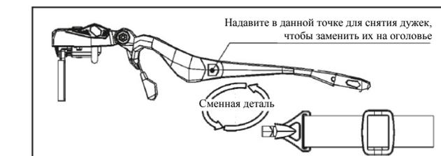
Дужки для лупы можно заменить на оголовье, чтобы обеспечить более комфортное и плотное ношение.
