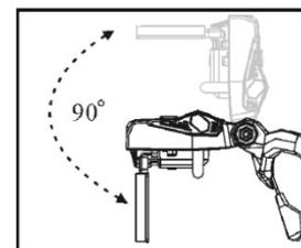
Линза и держатель имеют конструкцию с возможностью вращения вовнутрь и наружу.
